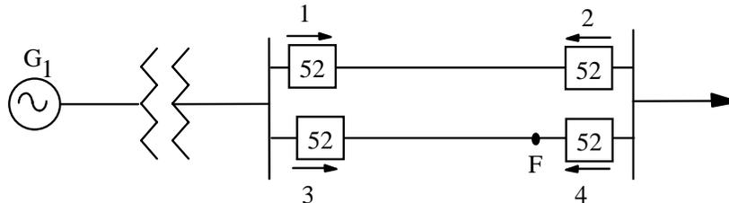
Figura 3.21.- Aplicación de la protección de sobrecorriente en una línea en doble circuito
