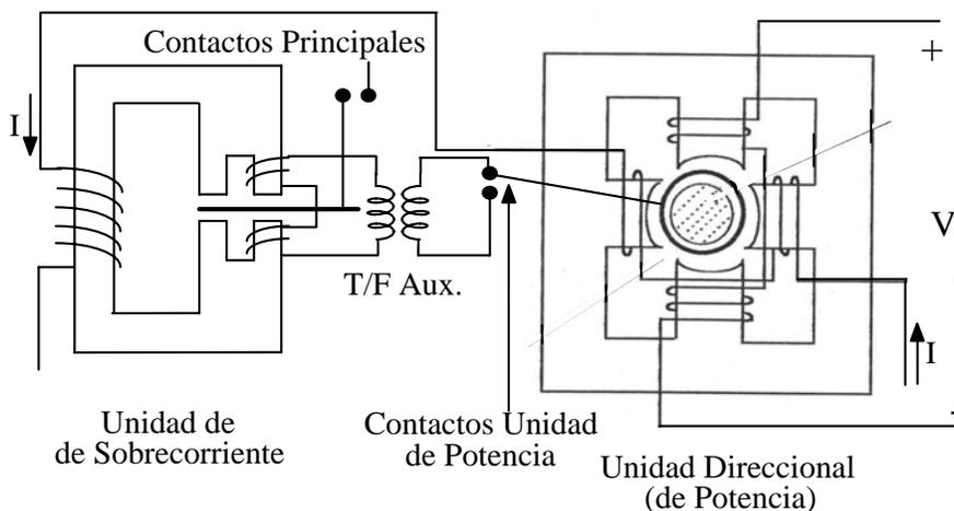
Figura 3.29.- Relé de sobrecorriente direccional IBC de G.E.
