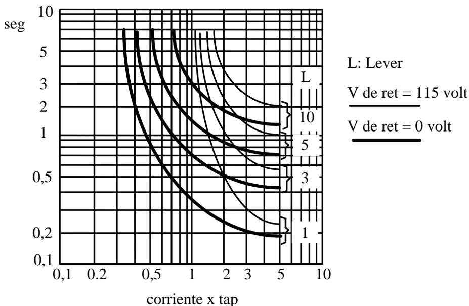
Figura 3.19.-Características tiempo-corriente de un relé de sobrecorriente con retención de voltaje
