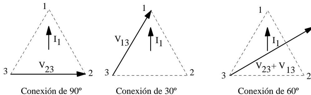
Figura 3.22.- Diagramas fasoriales para las conexiones del relé de la fase 1
