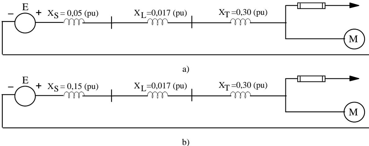
Figura 3.38.- Mallas de secuencia positiva. a) Generación máxima, b) Generación mínima
