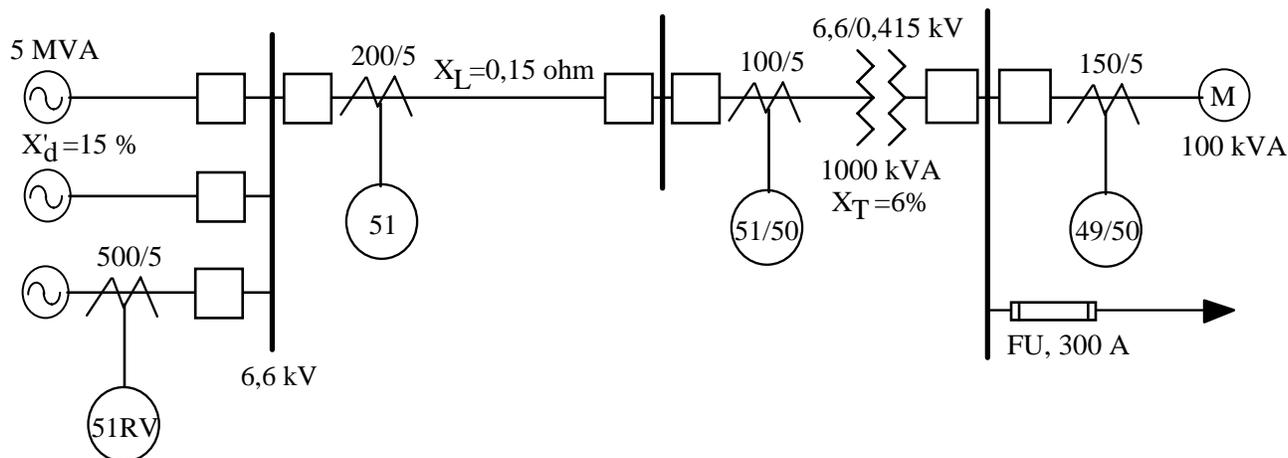
Figura 3.36.- Diagrama unilineal del sistema en estudio
