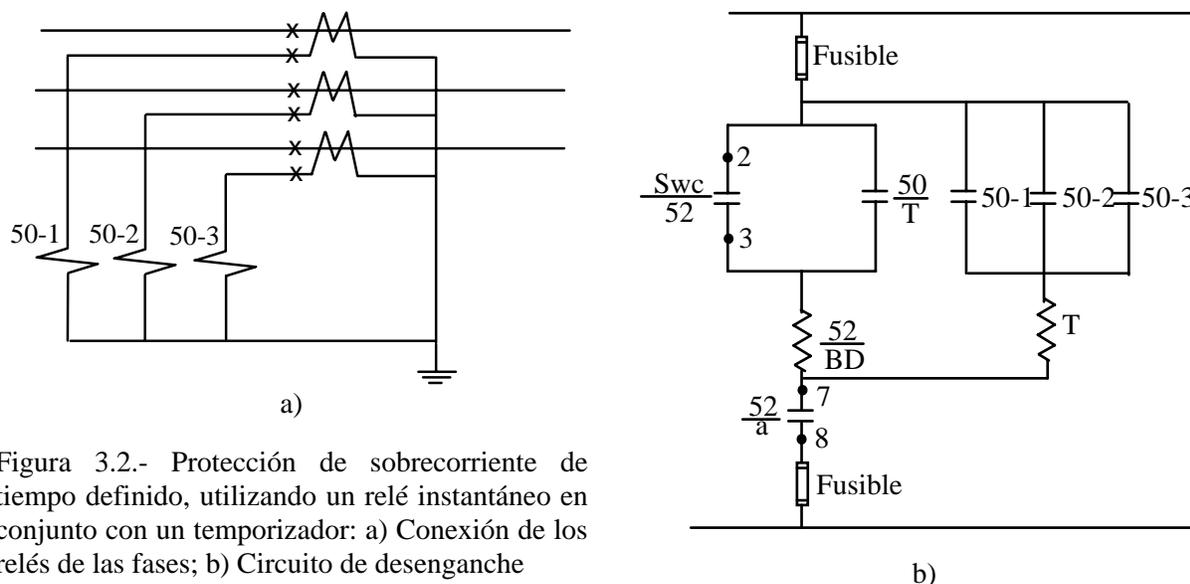
Figura 3.2.- Protección de sobrecorriente de tiempo definido, utilizando un relé instantáneo en conjunto con un temporizador: a) Conexión de los relés de las fases; b) Circuito de desenganche
